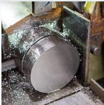
Corte de Blanks nossa empresa Barras Laminadas e Forjadas
