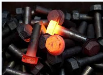
Fixadores Forjados a quente a partir de Barras Laminadas Desc.+Polidas;
