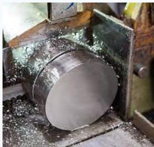
Corte de Blanks em nossa empresa De Barras Laminadas e Forjadas
